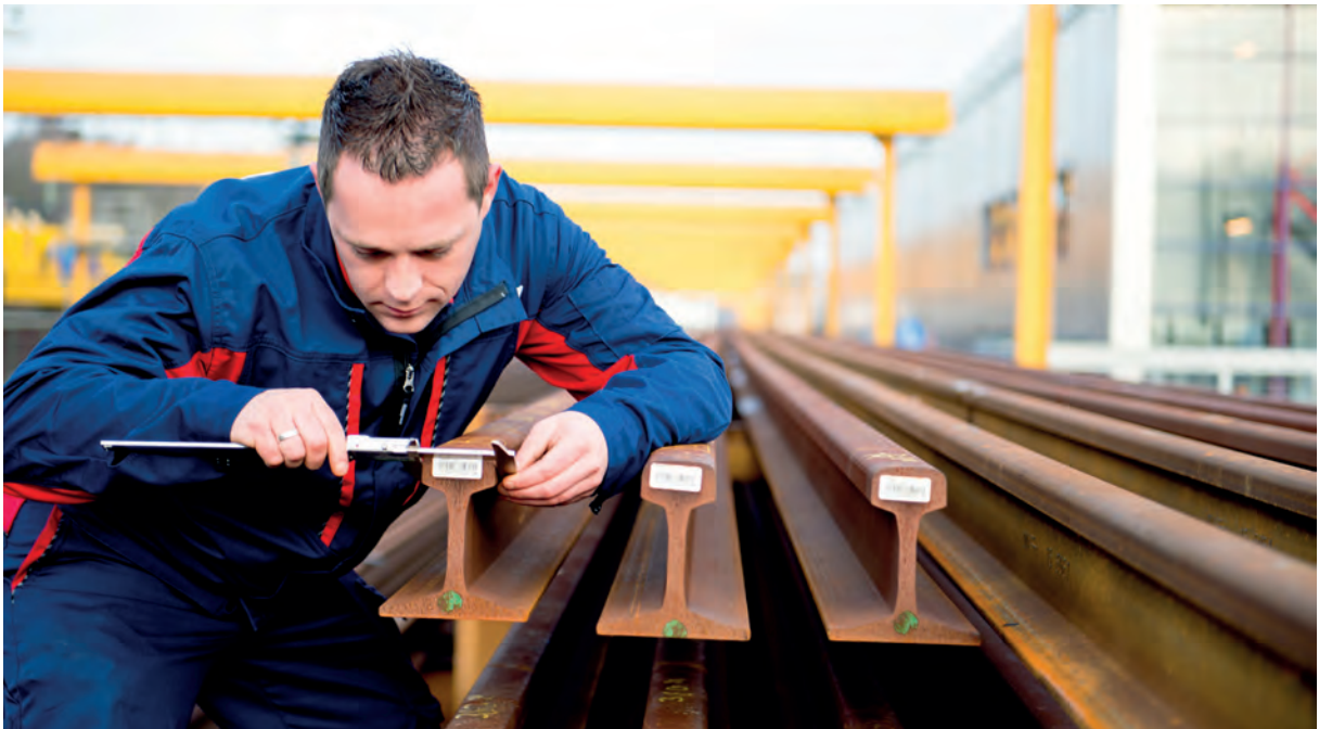
Voestalpine Track Solutions Netherlands B.V. bewerkt onder andere spoorstaven met verschillende profielen en staalsoorten, met lengtes tot 360 meter.
